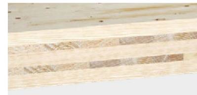
Strop z CLT panelů
